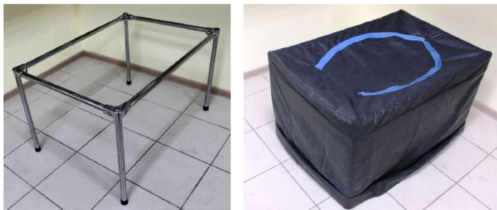
Рис. 1. Затемняющий столик для 3D-сканирования: слева – каркас, справа – чехол
